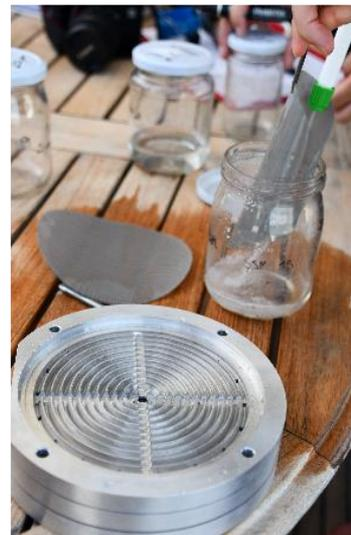
**Figura 3.** Apparato di filtrazione per il campionamento in colonna d'acqua.
